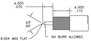
5. SLIDE DIELECTRIC STOP ONTO CENTER CONDUCTOR
